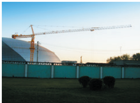
图 11-1-5 塔式起重机的吊臂也是杠杆
