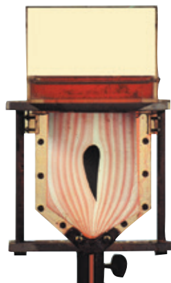
图 10-1-5 在流体力学实验室，可以用带颜色的水模拟鸟翼周围气流的分布情况
