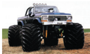
(d) 沙漠中的越野汽车装有非常宽大的轮子
