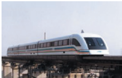
图 7-5-10 磁力把磁悬浮列车从轨道上微微托起,使接触面分离,减小摩擦
