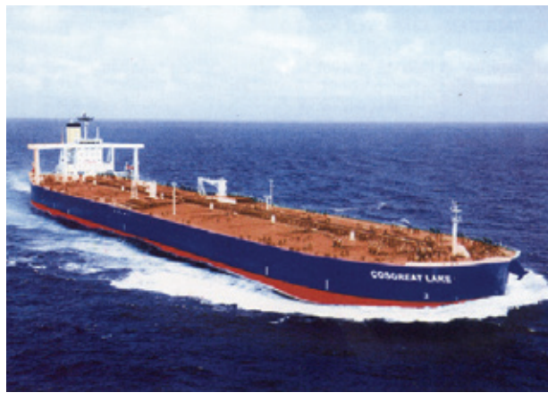
图11-5-8 庞然大物人造就——这是我国第一艘自行设计建造的超大型油轮“远大湖”号，于2002年下水。其排水量300000 t，船长333.5 m、型宽58 m、型深31 m；续航能力为3万海里；甲板面积相当于三个标准足球场，步行一圈要用十几分钟；总高度71.2 m，相当于层高2.6 m的24层大厦；船舱总容积量相当于80列15节车厢的列车。共用钢材44000 t
