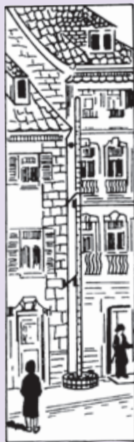
图 9-4-11 仿照托里拆利实验,格里克做了一个三层楼高的水气压计。通过长期的观测,他发现水柱高度的变化与天气有关。1660年他根据一次气压的突然下降,预报了一次大的暴风雨
