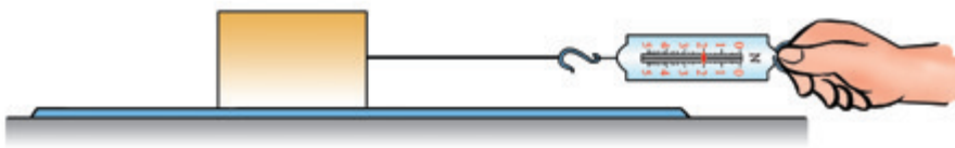
图 7-5-5 你很快就会学到，拉动木块匀速滑动，弹簧测力计的示数就等于滑动摩擦力的大小
