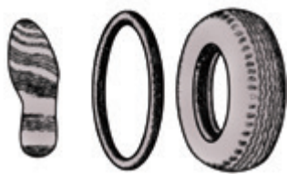
图 7-5-9 在鞋底、轮胎上做上凹凸不平的花纹,以增大摩擦
