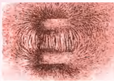
图 16-5 蹄形磁体周围铁屑的分布
