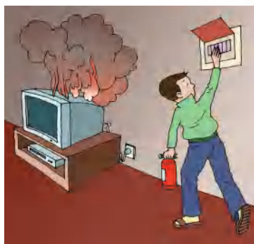
(e) 发现用电器或电线失火时, 应先切断电源, 然后再灭火
