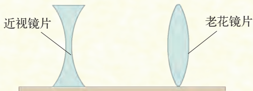
图 4-58 用近视镜片与老花镜片制成的望远镜
