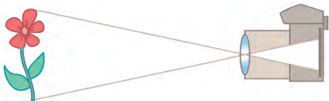
图 4-53 照相机的成像原理
