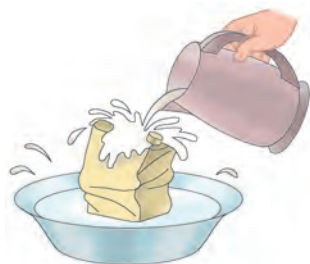
图 8-36 冷水浇铁皮罐实验
