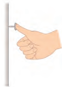
图 8-8 图钉对墙面的压强
