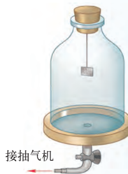
图 3-7 探究声音传播的实验装置
