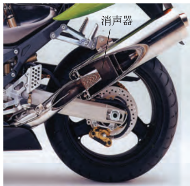
图 3-22 摩托车上的消声器
