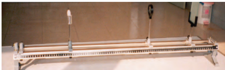
图 4-40 凸透镜成像实验的相关器材
