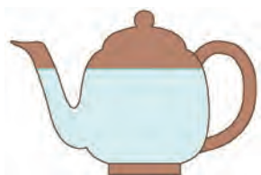
图 8-24 水壶利用了连通器原理
