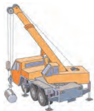
(a) 起重汽车放下支脚扩大支承面
