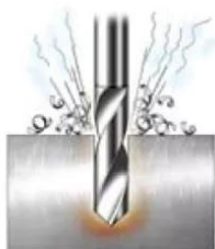
(a) 用钻头在金属块上钻孔时，钻头和金属块会发热，这是通过做功来改变物体的内能
