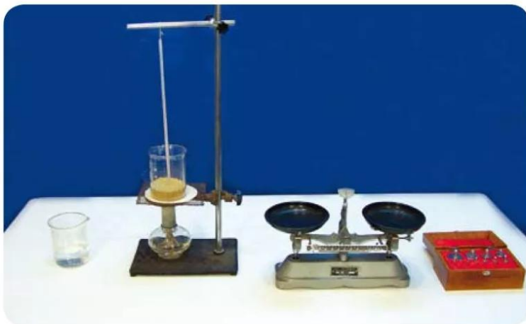
图12-11 探究水和砂石吸、放热性能的实验器材
