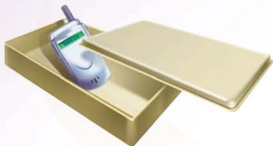
图 17-15 将手机放在金属容器内
