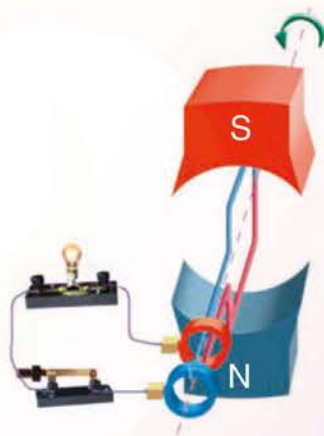
(b) 手摇发电机工作原理图
