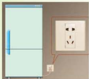
(a) 用电器的金属外壳一定要接地
