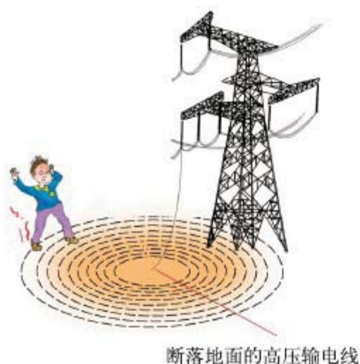
图 18-23 警惕跨步电压的伤害
