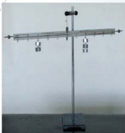
图 10-3 探究杠杆平衡条件的实验装置
