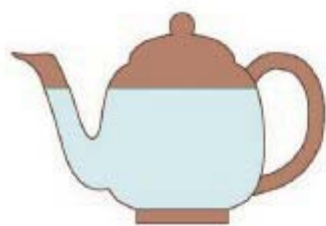
图 8-24 水壶利用了连通器原理
