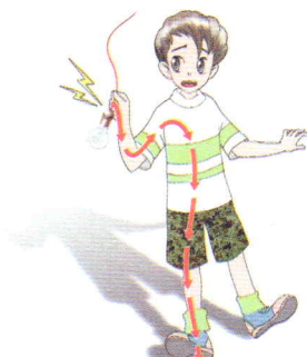
(b) 人触到了破损电器中的火线，电流流过人体入地，很危险
