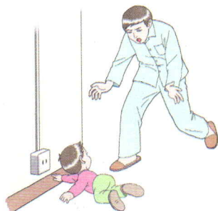
(c) 没有安全措施的插座安装过低，小孩玩耍时容易将手指塞进插座，造成触电事故
