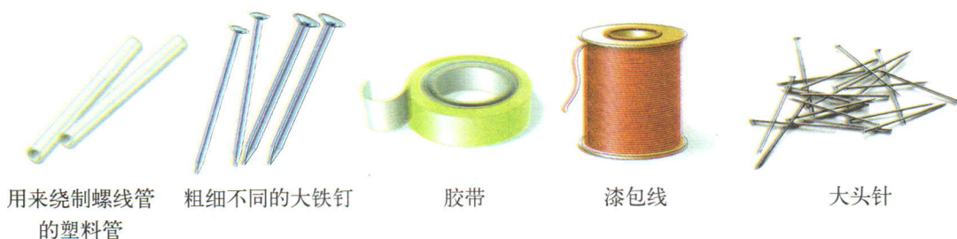
图 16-24 研究电磁铁磁性的实验器材
