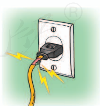
图 19.2-2 绝缘皮破损容易造成短路
