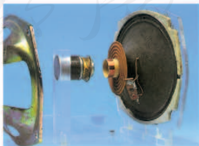
图 20.4-8 扬声器的结构
