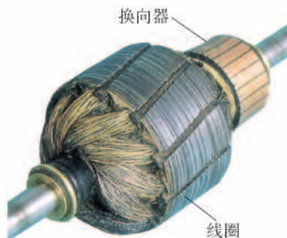
图20.4-7 实际的直流电动机的转子
