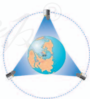
图21.4-5 用三颗同步卫星就可以实现全球通信
