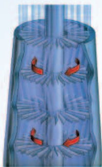
图14.2-5 高温高压水蒸气直接推动蒸汽机的叶片
