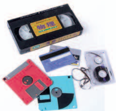
图20.5-8 利用磁性材料记录信息的产品
