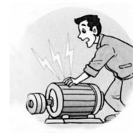
C. 电动机外壳没有接地
