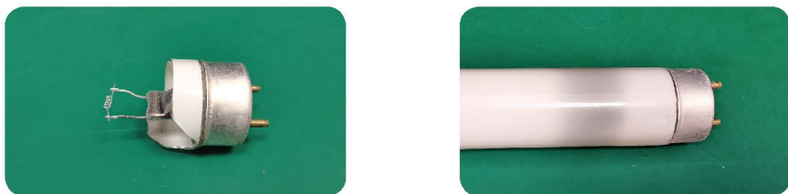
图 1.4-1 日光灯灯丝和变黑的日光灯玻璃管
