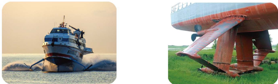
图 8.4-7 高速行驶的水翼船和水翼结构
