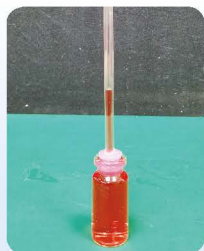
图 1.1-2 自制液体温度计
