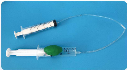
图 9.3-5 两个连有软管的注射器针筒
