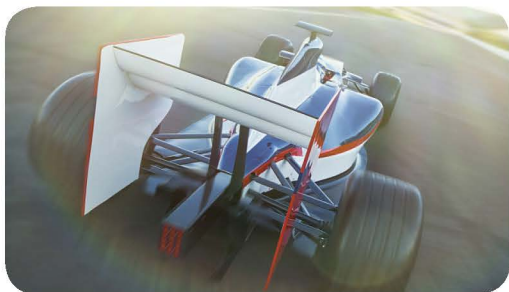
图 8.4-8 赛车的气流偏导器
