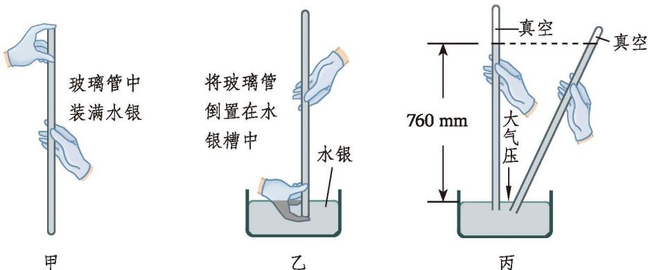
图 8.4-4 托里拆利实验（示意图）
