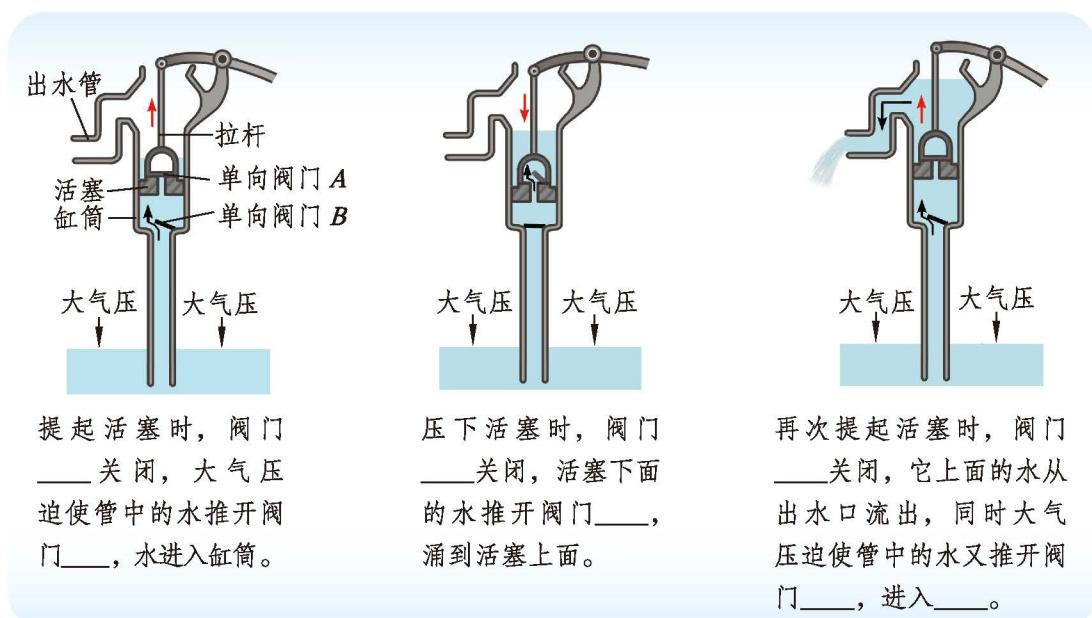
抽水机) 的结构及工作过程的示意图，它的主要结构包括缸筒、活塞、拉杆及单向阀门 A、B。为了加强阀门的密封性，使用前通常要先向缸筒内灌些水。请你描述活塞式抽水机的工作过程，并把图下面的文字补充完整。
