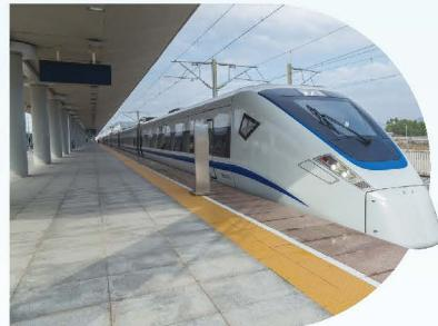
图 8.5-13 火车站台上的安全线
