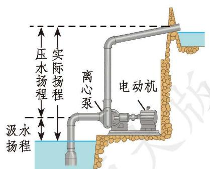
图 8.4-11 离心式水泵的扬程
