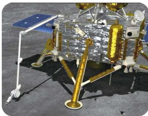
图9.6-4 嫦娥五号自动采样的机械臂设计利用了杠杆等机械,其动力来源于安装在各个关节处的电动机,它们如同人体手臂乃至手掌的肌肉一样,驱动机械臂完成相应的动作。嫦娥五号探测器成功完成月壤取样任务,使我国成为世界上第三个取回月壤样本的国家。
