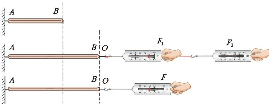
图 7.4-2 同一直线上方向相同的二力的合成
