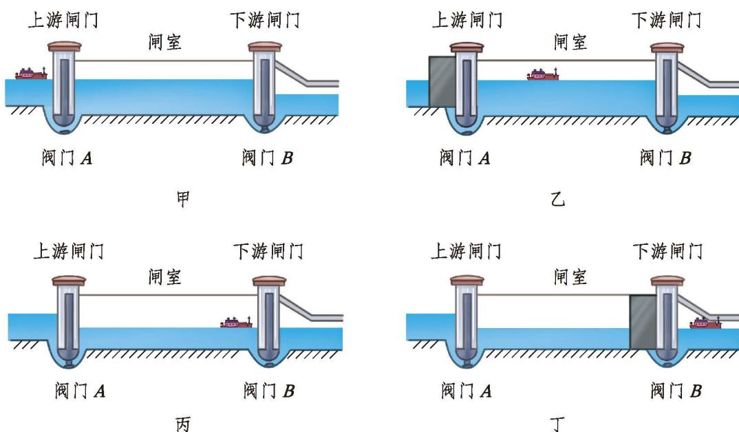
图 8.3-8 船闸的工作过程（示意图）
