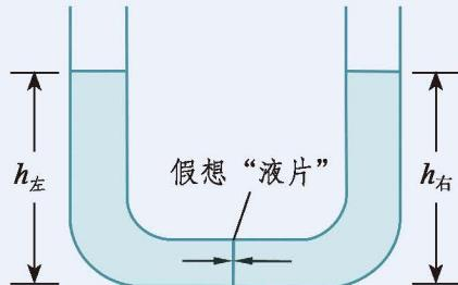
图 8.3-3 连通器原理（示意图）
