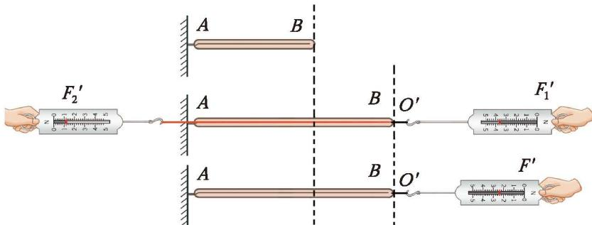
图 7.4-3 同一直线上方向相反的二力的合成
