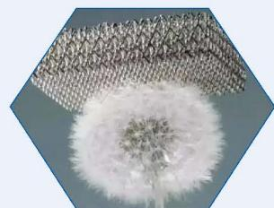
图 6.4-4 微晶格材料
