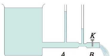
图8.5-2 液体压强与流速的关系
