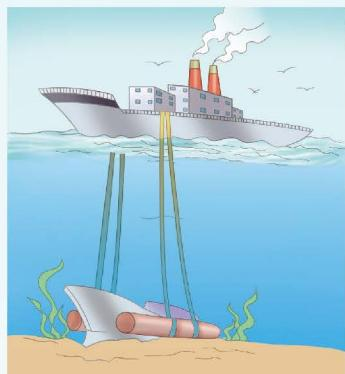
图 8.7-10 利用“浮筒打捞法”打捞沉船
