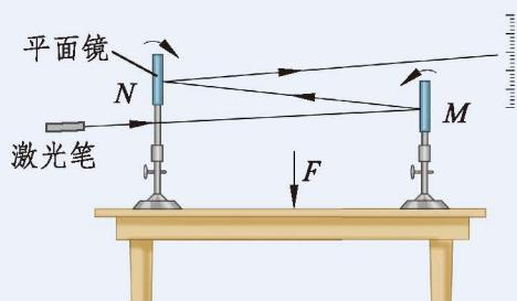
图 7.2-11 利用光的反射演示桌面的微小形变
