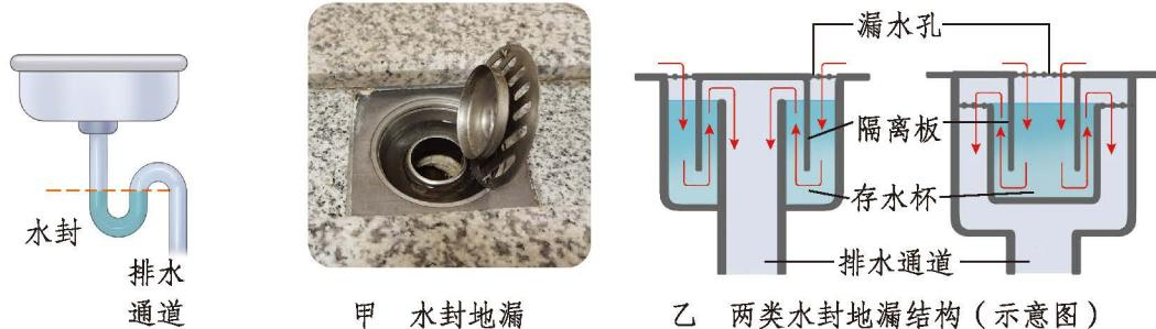
图 8.3-6 洗手池下水的回水弯
