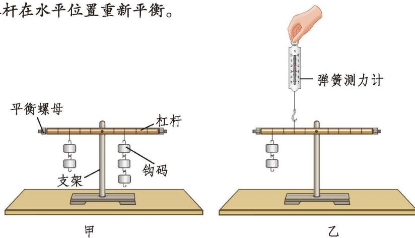
图 9.1-6 探究杠杆的平衡条件
