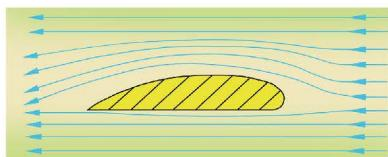
图 8.5-6 气流流过机翼
