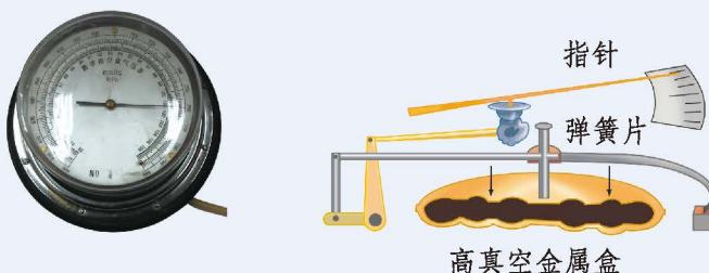
图 8.4-7 金属盒气压计及其结构（示意图）
