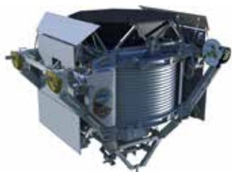
图 7-1-2 阿尔法磁谱仪(AMS-02)的核心部件是一个直径1.2 m、重约 2.6 t 的环形巨大永磁体
