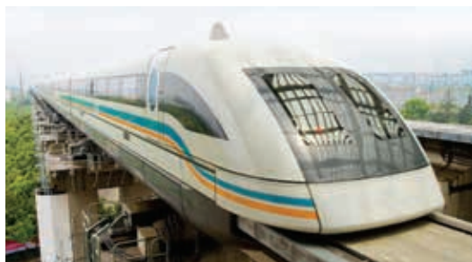
(b) 磁悬浮列车的轨道上安装着大量电磁铁，使列车悬浮“飞行”
