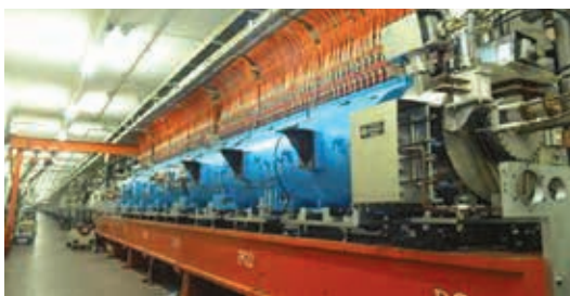
(d) 在北京正负电子对撞机中，使用了大量的电磁铁
