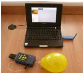
图 1-2-7 应用温度—压强传感器可以探究气球破裂瞬间球内气体温度和压强的变化
