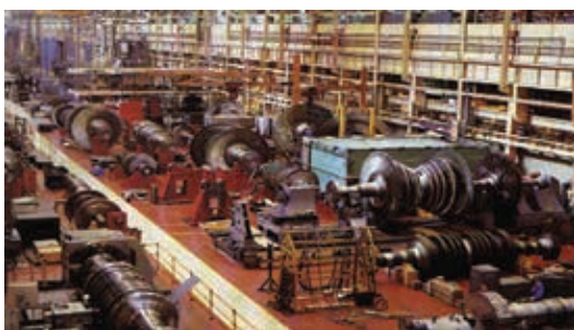
(d) 轮机广泛应用在现代大型火力发电厂，这是生产蒸汽轮机的车间
