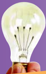
图 6-3-1 电流通过灯丝时，电能转化为内能，灯丝变得灼热而发光
