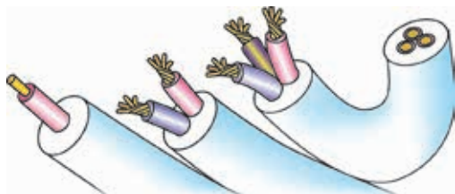
图 4-3-4 好的导体和绝缘体都是重要的电工材料。观察电线，你能指出哪些部分是导体，哪些部分是绝缘体吗
