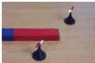
图 7-1-6 在磁体周围的不同位置，小磁针会指不同的方向
