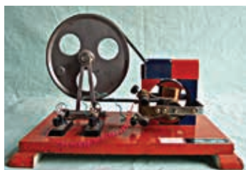
图 8-1-8 实验室里的手摇发电机能产生交变电流
