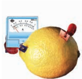
图 4-1-4 柠檬电池能产生 0.03 A 的电流
