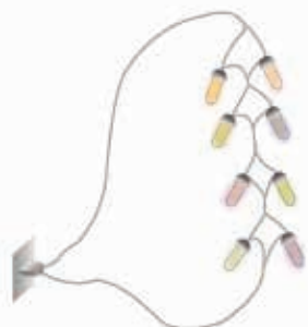
图 3-4-3 改进的彩灯连接方式
