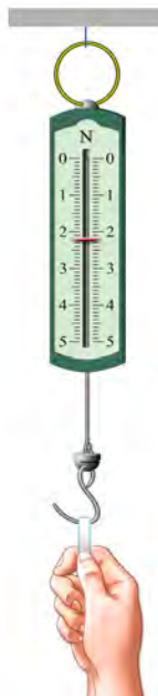
图6-14 测量纸条能承受的拉力
