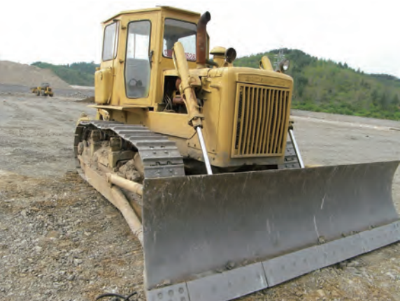
(c) 推土机的履带对地面的压强约为 3 \times 10^4 Pa
