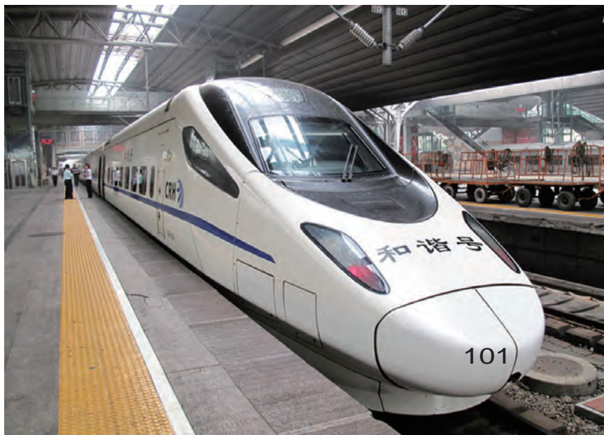
图9-30 高铁站台上的安全线
