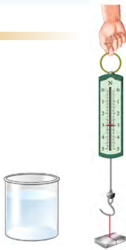
图9-2 测量浮力的实验
