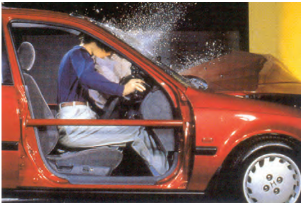
图7-32 未使用安全带防护措施的模拟碰撞实验
