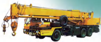
(d) 汽车起重机的功率可达 320 kW
