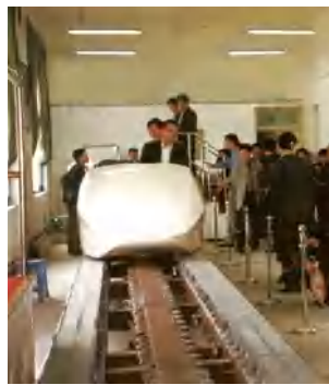
图14-24 载人高温超导磁悬浮试验车“世纪号”
