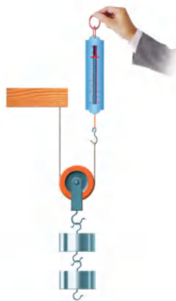
图 11-18 用动滑轮拉起钩码
