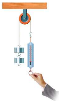
图 11-17 用定滑轮提升钩码
