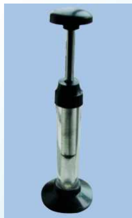
图 12-31 空气压缩引火仪
