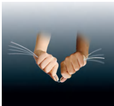
图 12-30 反复弯折铁丝
