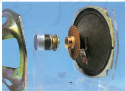
图 20.4-8 扬声器的结构
