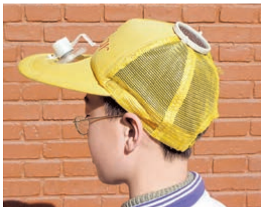
图22.3-6 太阳能凉帽。电池板把太阳能转化为电能，从而驱动电动机。
