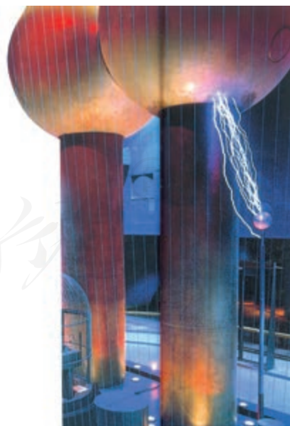
图16.1-1 起电机的高压放电
