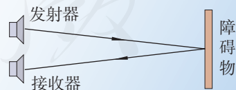
图1.4-3 超声波测距原理
