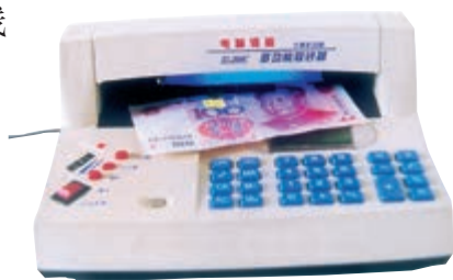
图4.5-7 紫外线使钞票上的荧光物质发光
