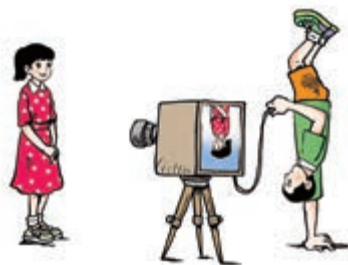
乙 照相机成缩小、倒立的像
