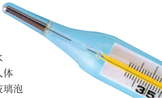
图3.1-4 体温计 (细管处水银柱断开)
