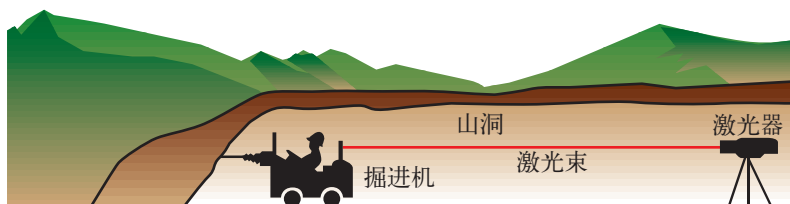
图4.1-4 激光引导掘进方向
